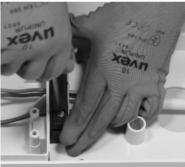
12. Installez la ferrite autour des câbles d'alimentation à la base du bloc de joints.
