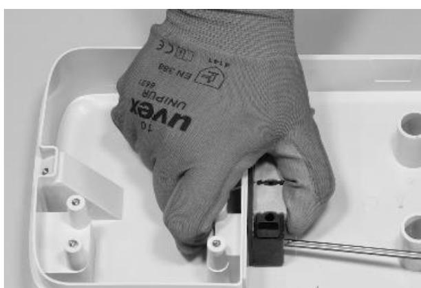
Pour la vis de gauche, l'écrou se situe derrière la base :
