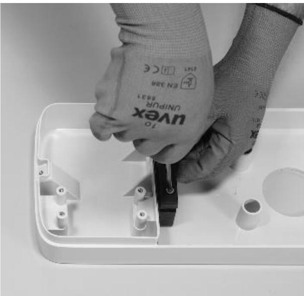
4. Identifiez les vis à écrou qui fixent le bloc de joints. Maintenez l'écrou en place avec une clé de taille 8, puis desserrez la vis avec une clé hexagonale de taille 4.
